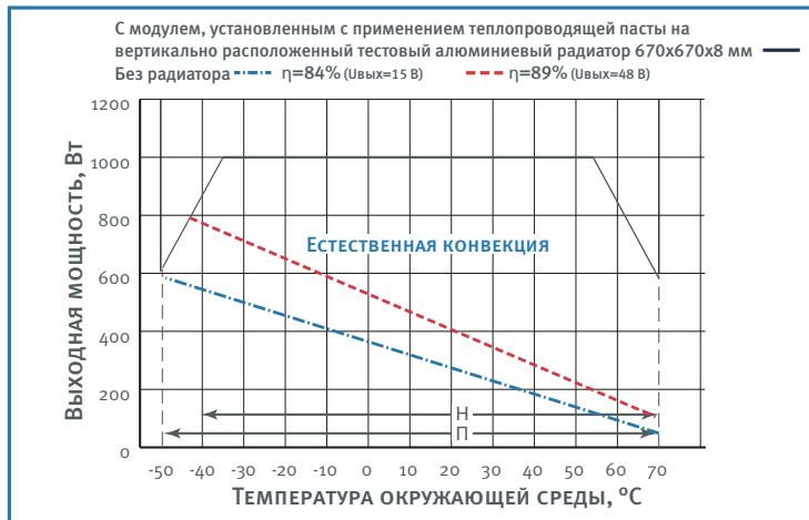
Спадающие участки пунктирной и штрихпунктирной кривых соответствуют максимальной температуре корпуса (для модулей с индексом «Н», «П» равной +85°C). Выходная мощность модуля не должна превышать значений, ограниченных соответствующей кривой при заданной температуре окружающей среды.
